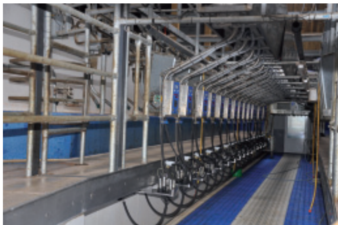
La salle de traite d'une capacité de 100 vaches par heure compte 2 x 20 postes de traite de type "Swing-Over". Comme elle est située au cœur de l'étable, un pont amovible permet le passage des vaches d'un côté à l'autre.
