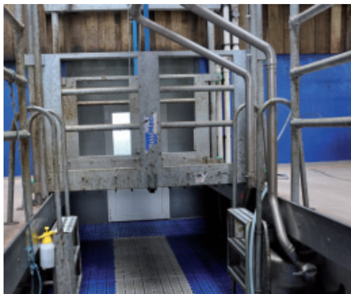
La salle de traite d'une capacité de 100 vaches par heure compte 2 x 20 postes de traite de type "Swing-Over". Comme elle est située au cœur de l'étable, un pont amovible permet le passage des vaches d'un côté à l'autre.
