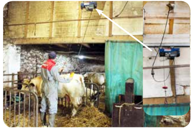
Le treuil monté sur rail, une aide pour sortir le veau lors d'une césarienne conçu par Pierre Halleux.
