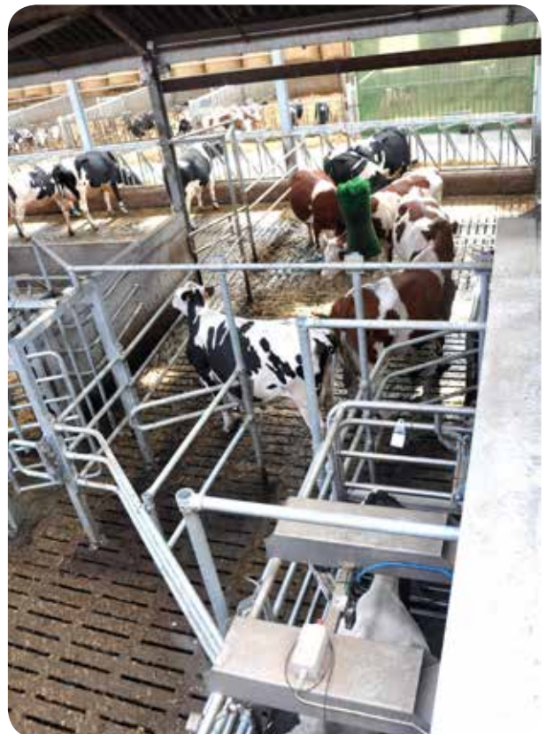
Le robot est équipé d'une porte de tri de sortie intégrée (une particularité du nouveau Merlin) ce qui demande moins d'espace et est plus économique à installer.
