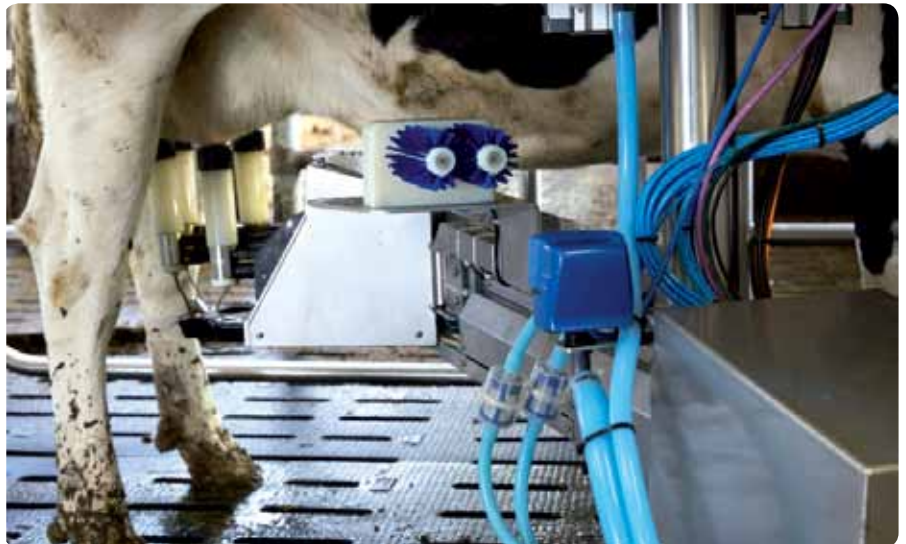
M 2 erlin est équipé d'un nouveau bras de traite très peu énergivore et d'un écran tactile pour une gestion simplifiée des vaches.
