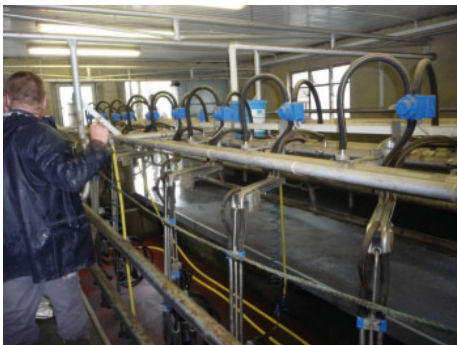
Les bâtiments sont fonctionnels mais sans aucun luxe. L'installation de traite classique est de type 2 x 10 ligne haute avec un équipement simple de type swing-over.
